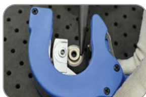
2. Retire a lâmina antiga com um alicate
