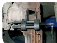
Ferramenta especial para retornar o êmbolo à sua posição inicial e permitir a troca das pastilhas de freio
