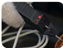
A luz acende quando detecta tensão
