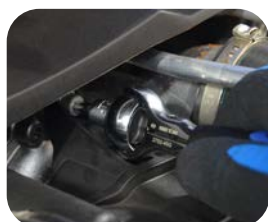
Articulação dupla, função multiangular na catraca e no cabo
