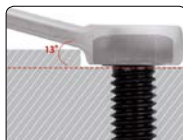
Extremidade estrela com inclinação de 13 graus: Melhor acesso
