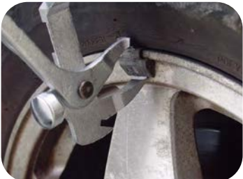
Fixa e remove os pesos de balanceamento
