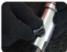
Seletor de sentido para aperto e desaperto
