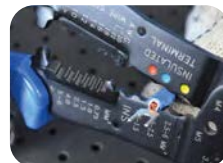
Crimpa terminais pré-isolados de 0,5 mm a 6 mm
