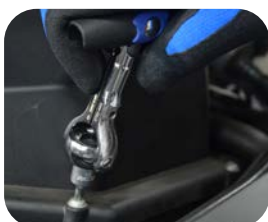
Articulação dupla, função multiangular na catraca e no cabo
