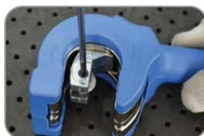
1. Desparafuse a lâmina com uma chave de fenda cruzada
