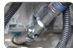
Retenção por esferas
