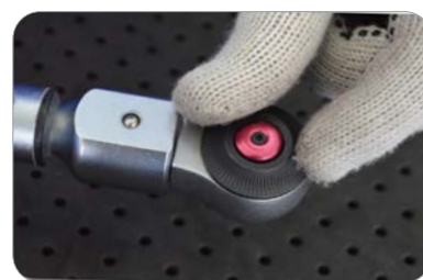
Trava de reversão. Ajuste de sentido normal e reverso
