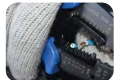
Desencapa fios de 0,75 mm 2 a 5,6 mm 2 e AWG com bitolas de 20-10
