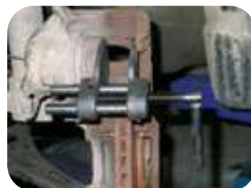
Ferramenta especial para retornar o êmbolo à sua posição inicial e permitir a troca das pastilhas de freio
