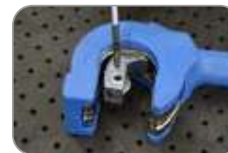
4. Coloque a lâmina nova no lugar da antiga e a prenda com o parafuso
