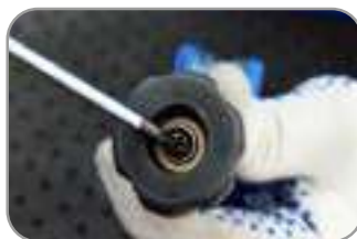
3. Pegue a lâmina nova, devolva a antiga, esta serve de ajuste a manopla
