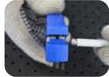
Desencapa cabos coaxiais sem danificar a manta
