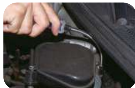
Trama interna que evita dilatação e permite o alcance
