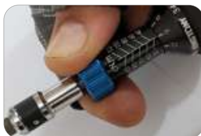
Segure o anel e gire o cabo para ajustar o torque desejado
