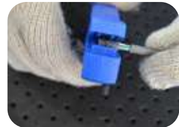
Ideal para desencapar cabos UTP/STP 2,6-8mm
