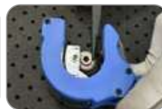
2. Retire a lâmina antiga com um alicate
