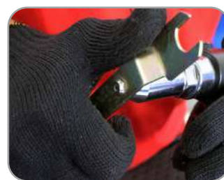
Pontas fixadoras de 2.4, 3.2, 4 e 4.8 mm
