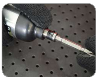
Encaixe com anel de retenção e esfera de aço para power bit
