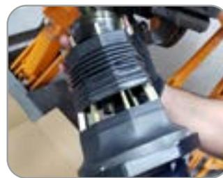
Posicione a coifa elástica sobre a junta homocinética e pressione o botão de liberação de pressão, para o retorno das garras e sua posição inicial e instalação da peça
