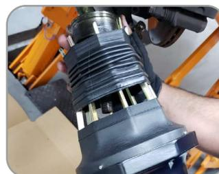
Posicione a coifa elástica sobre a junta homocinética e pressione o botão de liberação de pressão, para o retorno das garras e sua posição inicial e instalação da peça
