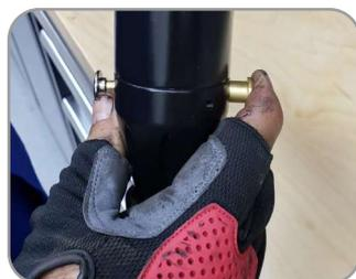
Pressione o gatilho de acionamento até o diâmetro ideal para o encaixe sobre a junta homocinética, expandindo a coifa. As garras expandem-se até o diâmetro máximo de 110mm
